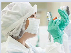
裸針检查(全检):(净化车间) 針の検査(全数):(環境管理区域内)
