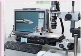
图像处理装置 画像処理装置
