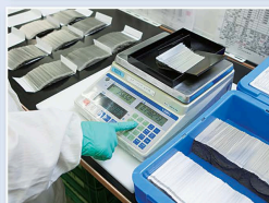
统计数量(净化车间) 針の計量(環境管理区域内)
