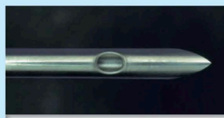
加工技术 电解加工 人工透析用AVF针
